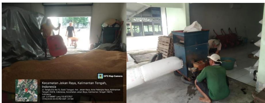
Gambar 54. Pemisahan calon benih dari kotoran fisik berupa Jerami, gabah hampa, dan kerikil menggunakan seed cleaner
